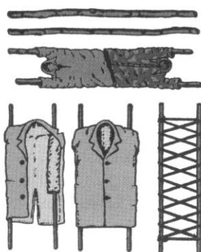
Рис. 24. Изготовление носилок из подручных средств.
